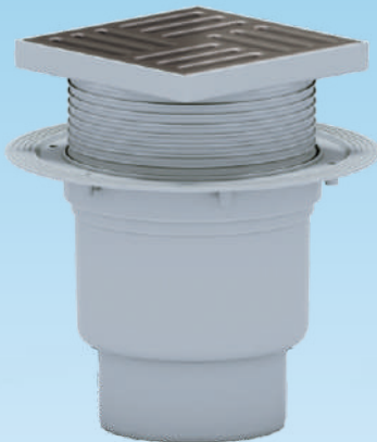
TA1716 Трап вертикальный регулируемый с выпуском 110 мм, с чугунной решеткой 150x150 мм
